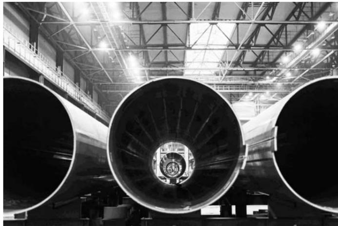
лазерным лучом воронку и обеспечивает надежное соединение кромок. Внутренние и наружные облицовочные швы выполняются по традиционной технологии ДСФ. В итоге комбинированный способ сварки позволяет сократить тепловложение и увеличить эффективность производства.
